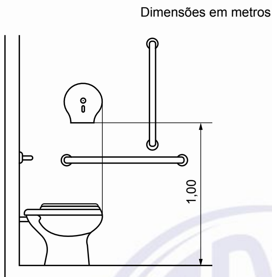
Figura 125 – Localização da papeladeira de sobrepor (rolo) – Vista lateral
