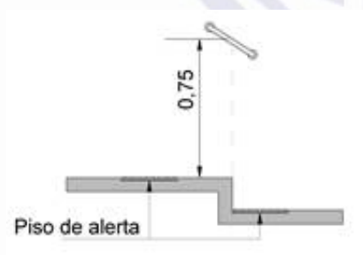
a) Barra de apoio inclinada
