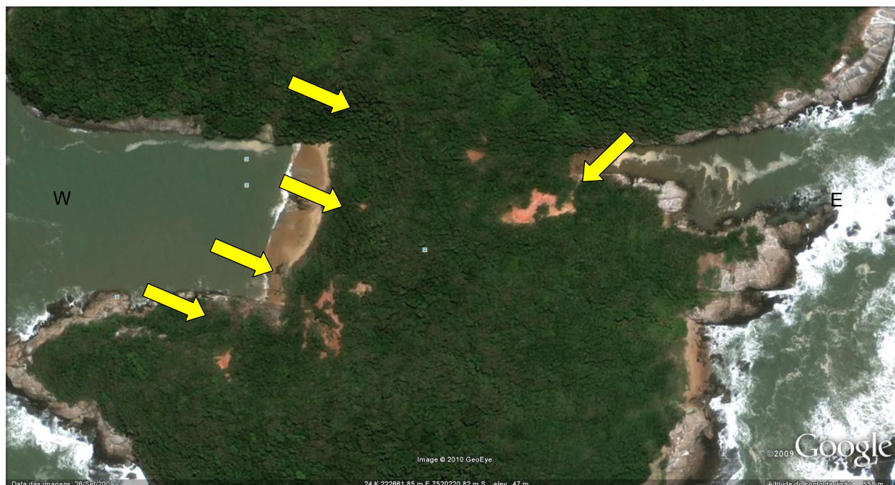
Figura 2 – Imagem de satélite mostrando alguns locais de ocorrência de erosão, nas encostas a leste e a oeste da Ilha do Francês. A situação atual apresenta um processo mais avançado em ambos os lados, principalmente na encosta a oeste (W) (Fonte: GoogleEarth).
