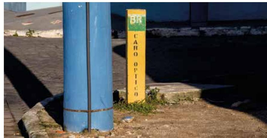
EM FUNÇÃO DE MACAÉ SER O MUNICÍPIO MAIS RELEVANTE PARA A ECONOMIA DO PETRÓLEO, DIVERSAS INFRAESTRUTURAS FORAM CONSTRUÍDAS PARA GARANTIR O ADEQUADO DESENVOLVIMENTO DAS ATIVIDADES. DO LADO ESQUERDO SE OBSERVA UM GASODUTO E DO LADO DIREITO UMA LINHA DE CABOS ÓPTICOS. AMBOS ENTERRADOS E COM SUA LOCALIZAÇÃO APONTADA POR TOTENS DA PETROBRAS.
