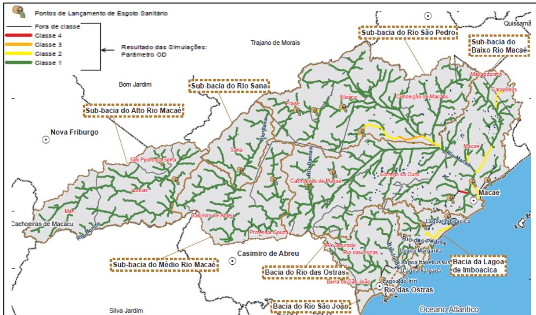
**Figura 88 - Simulação da qualidade da água (parâmetro OD) no ano 2032 para a vazão  $Q_{7,10}$ .**
