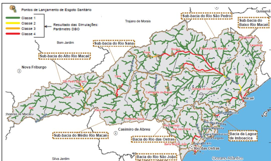
Figura 87 - Simulação da qualidade da água (parâmetro DBO) no ano 2032 para a vazão Q<sub>7,10</sub>.
